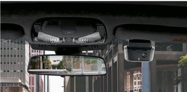
○ A BMW Advanced Car Eye 2.0 egy igen érzékeny full HD kamera, ami akár parkolás közben is rögzíti az autó előtt és mögött történő eseményeket. Az autón kívüli szokatlan vagy zavaró mozgás esetén a kamera automatikusan rögzíti a helyzetet a lehetséges balesetek vagy (megkísérelt) behatolások dokumentálása érdekében.
